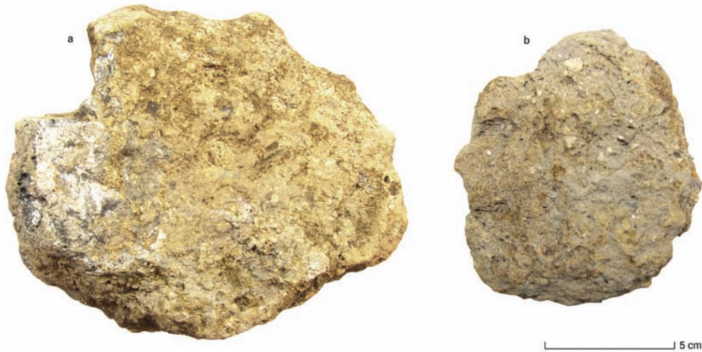
Afb. 9.2 Links: Planoconvexe smeedslak (vnr. 6646; KL690 in put 928). De slak is bedekt met een moeilijk te verwijderen korst. Aan de linkerzijde hecht leem van de haardwand, het deel daarvoor is verglaasd. Rechts: Planoconvexe smeedslak (vnr. 4394; put 959, S207), onderzijde. De slak heeft een licht hoekige vorm, mogelijk het gevolg van een hoekige smeedhaard.
