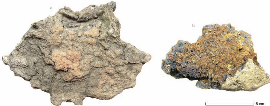
Afb. 9.4 a: Haardwand (vnr. 635; KL092 in put 960). Getoond wordt de achterzijde met resten gebrande leem. De voorzijde was naar de haard gericht en is deels verglaasd. b: Onregelmatig gevormde (mogelijke) wolf (vnr. 586; KL832 in put 942). De slak is vesiculair en licht. Aan dit fragment hechten nog delen van de haardwand.
